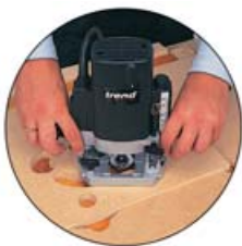
2. Umístěte šablonu a při frézování kopírujte výřezy.
